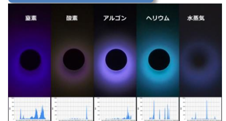
SLD-100 アルゴンガス感度特性 (大気圧校正後)
